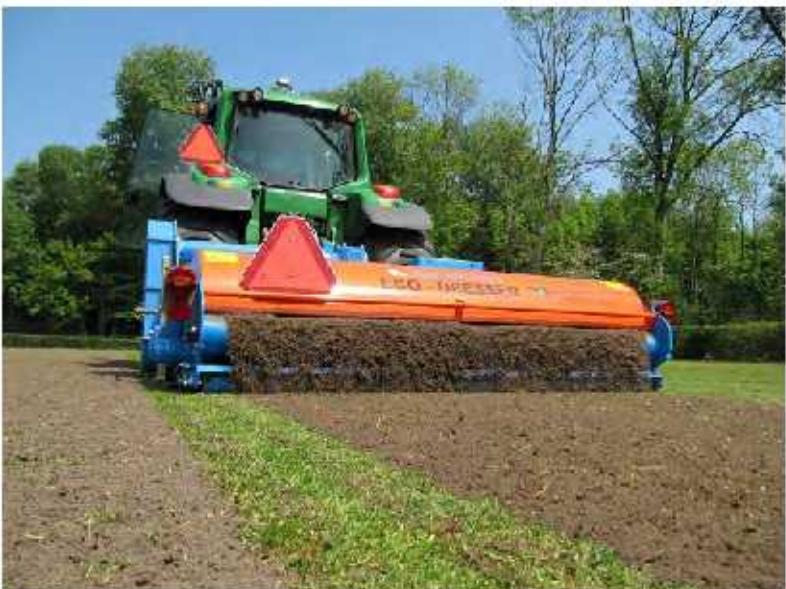
این دستگاه می تواند در حین هوادهی و کاهش فشرده‌گی تراکم، در محل کود را بازسازی کند. این دستگاه در ترمیم مکان‌های ورزشی، در مقابل روش‌های سنتی زهکشی، حلقه بقای چمن و عملیات کودپاشی روی سطح خاک، می تواند در مصرف انرژی صرفه جویی کرده و در قیاس با این روش‌های قدیمی ارزشمند باشد. علاوه بر کاهش هزینه‌ها، افزایش پایداری، کاهش انتشار کربن، کنار گذاشتن کودپاشی سطحی، بازسازی و بازیابی مواد مغذی، هوادهی و... از ویژگی‌های دیگر این دستگاه است.
