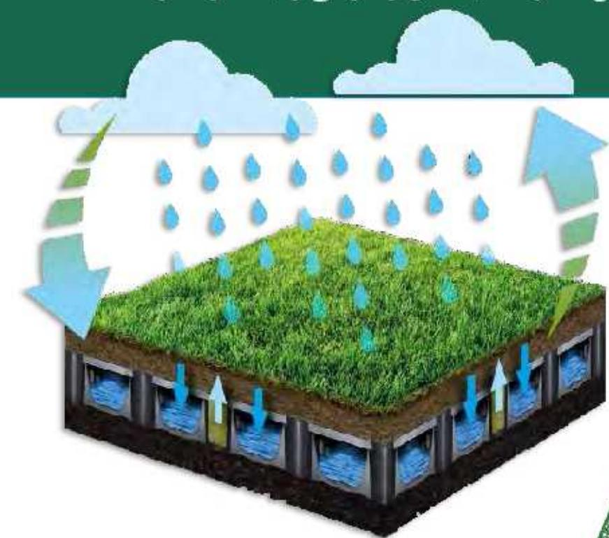
این سیستم قابلیتی دارد که دیگر سیستم های زهکشی آن را ندارند و می تواند هر زمان که نیاز باشد، به سرعت و به طور موثر آب زمین را تخلیه کند. این روش مخصوصا برای سیستم های آبیاری آب شور رایج است. قابلیت استفاده از این سیستم در هر دو حالت افقی و عمودی، نیاز به اساس سیستم های زهکشی سنتی همچون ترانشه های جناقی یا لوله های تخت را حذف می کند.
